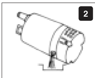
Fig. 2 : couchez la pompe sur le côté. Vidanger l'huile toute dans un bac de récupération
